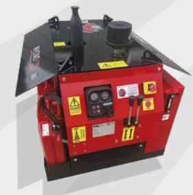
Le groupe hydraulique **80** est propulsé par un moteur diesel Kubota V1505 de 25 Ch, démarrage électrique et équipé d'un levier de commande d'accélérateur à vitesse variable. L'unité est conçue pour une facilité d'entretien. Le débit hydraulique est produit par une seule pompe alimentant une vanne de commande à double tiroir qui permet à l'opérateur d'ajuster au mieux le débit (60/80/100 L/Min.).
