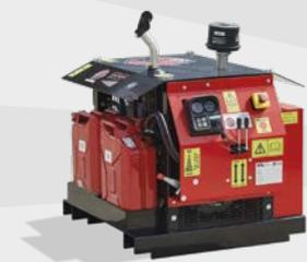
Le groupe hydraulique **40** est propulsé par un moteur diesel Kubota 2602 de 13,5 Ch, démarrage électrique. L'unité légère est conçue pour une facilité d'entretien. Le débit hydraulique est produit par une seule pompe alimentant une vanne de commande à double tiroir qui permet à l'opérateur d'ajuster au mieux le débit (40/50/60 L/Min.).
